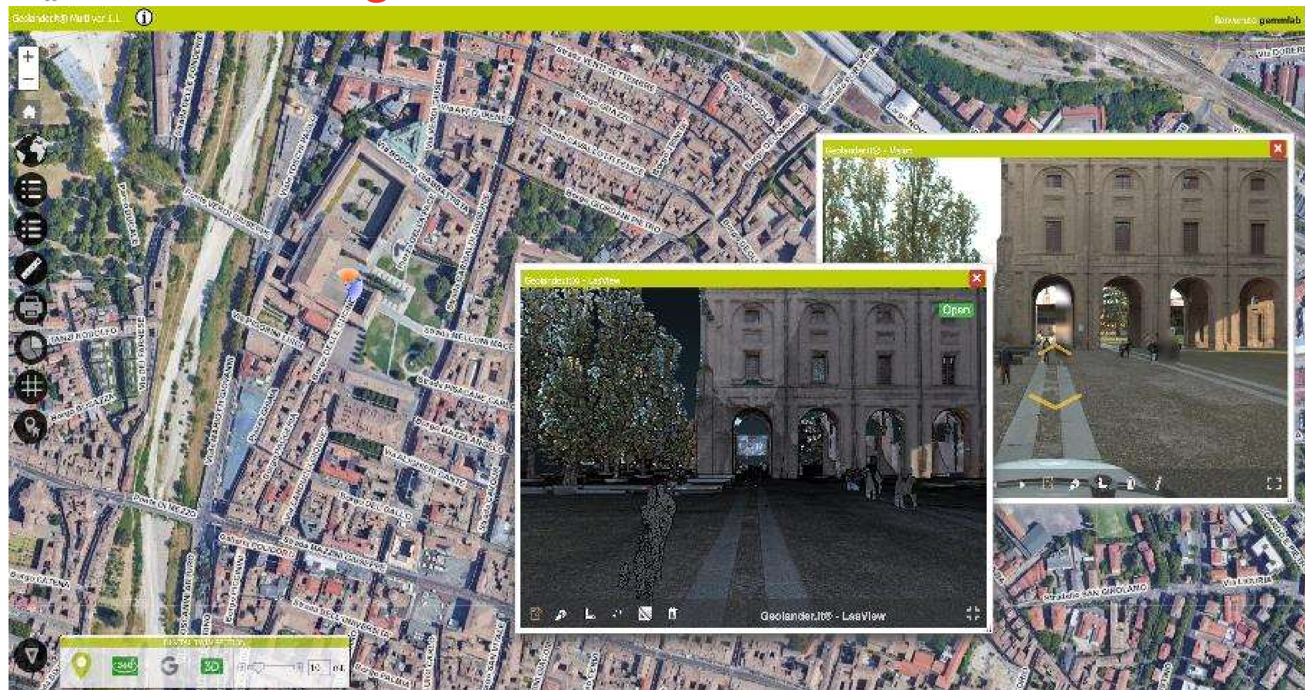
Sistema a nuvole di punti ad altissima risoluzione (5cm) e immagini navigabili con georeferenziazione di ogni dato
